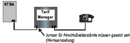
Dies ist die einfachste Anschlussvariante. Sie eignet sich auch hervorragend dazu, beim Betrieb von mehreren TarifManager ISDN-Geräten an größeren Telefonanlagen zunächst jedes Gerät individuell zu konfigurieren.
